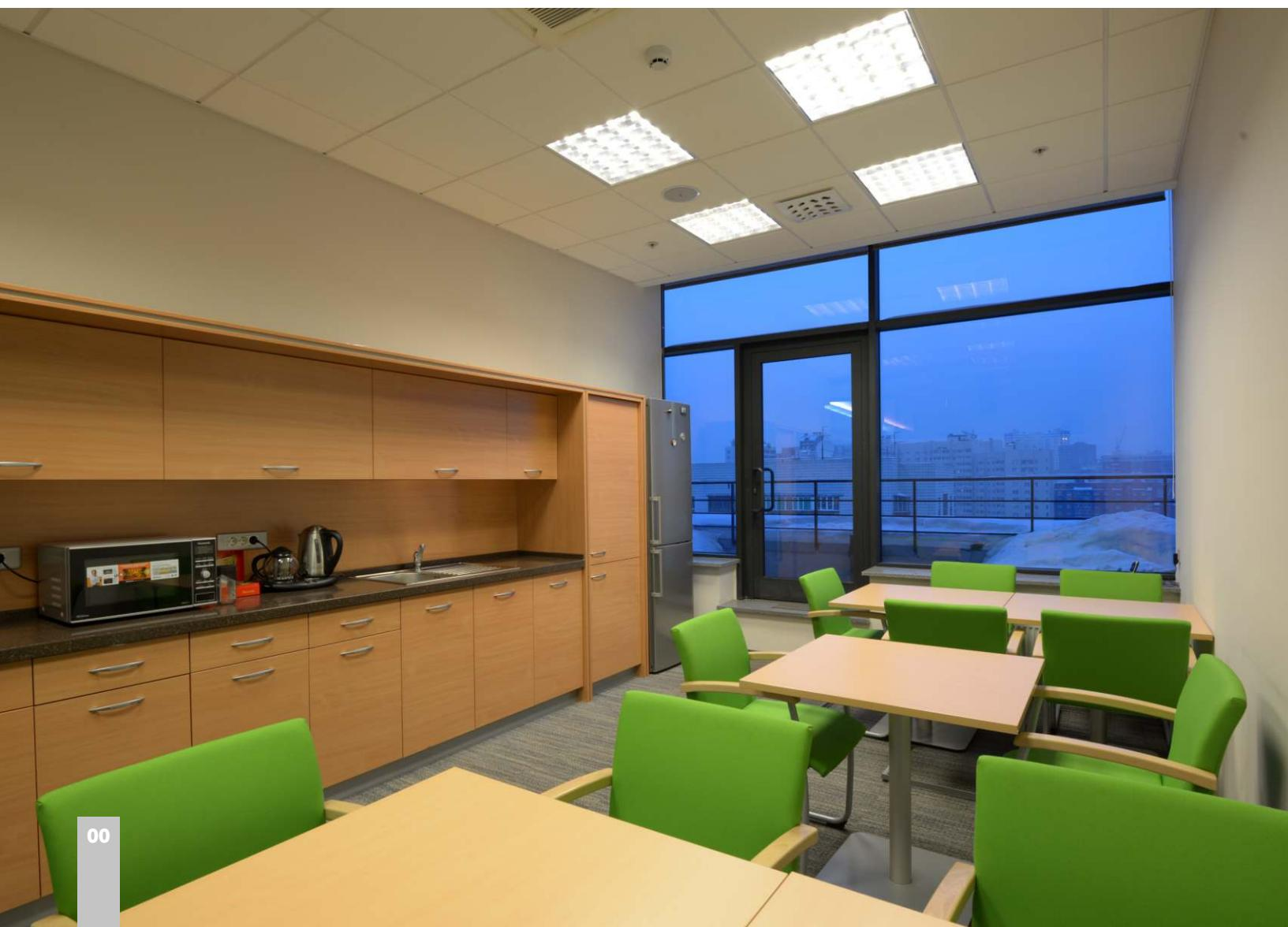
**TEKNİK ÖZELLİKLER****Standartlar;** DIN EN 13501-1**Malzeme Yapısı;** Mineral Wool**Perforasyon Tipi;** Dağınık Kurtçuklu**Plaka Kenar Detayları;** Küt Kenar yada Sarkmalık kenar Kullanılır.**Plaka Boyutu;** Projeye Uygun 600x600 veya 600x1200 mm**Plaka Kalınlığı;** 12 mm ve 15 mm Kalınlıkta Olacaktır.**Taşıyıcı Sistem;** Korozyona Dayanıklı Sıcak Daldırma Galvenizli Sacdan Form Tekniği ile
